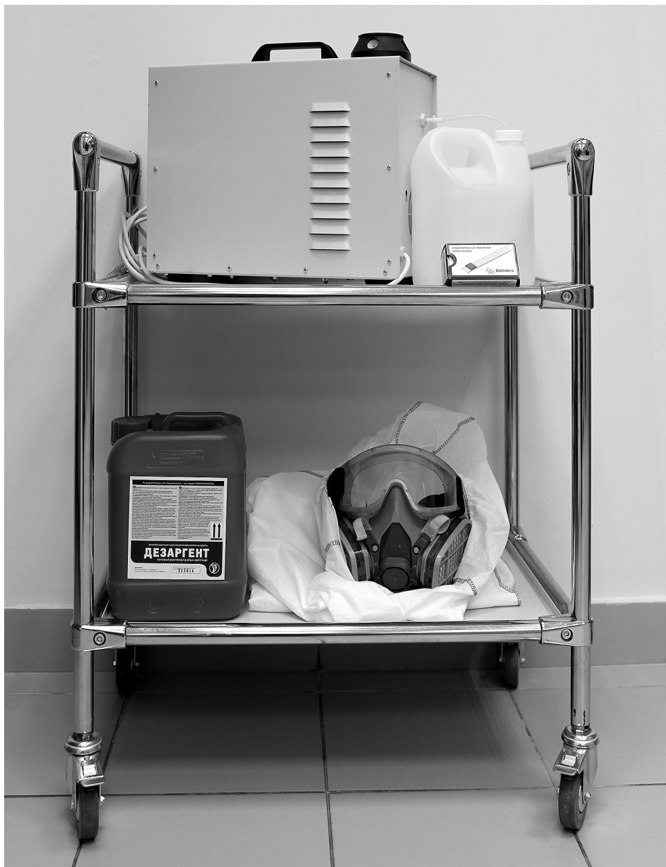
Фото 1. Распылитель «Ультраспрейер Р-60М», укомплектованный СИЗ, канистрой дез.средства «Дезаргент», тест-полосками.
