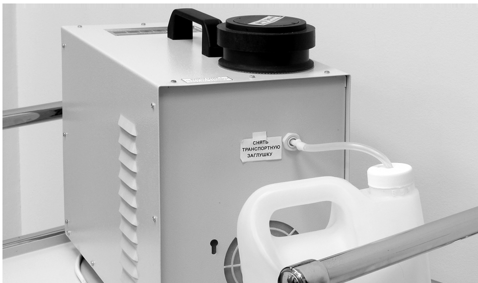
Фото 2. Подсоединение заборного устройства на корпусе распылителя.
